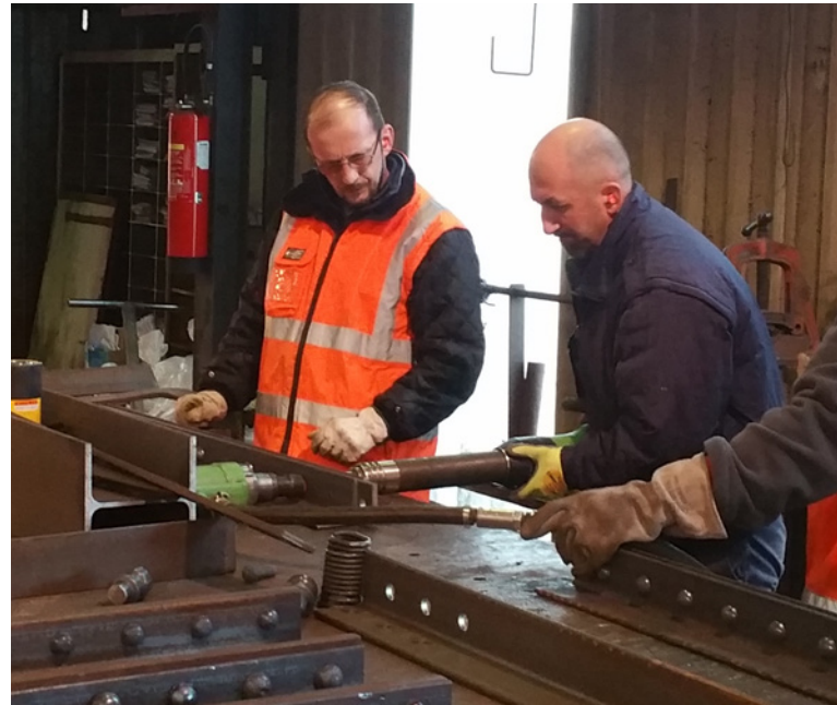
Rivetage dans les ateliers de SMB
