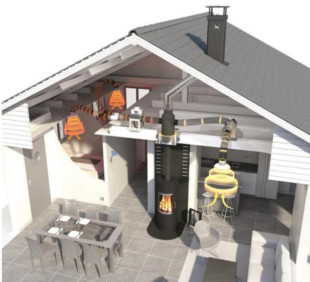
**AIRWOOD Confort +** est la solution de récupération et de distribution d'air chaud compatible avec tous les types d'appareils de chauffage au bois, foyer fermé, poêle à bois ou poêle à granulés, quels que soient leur puissance et leur mode de fonctionnement.
