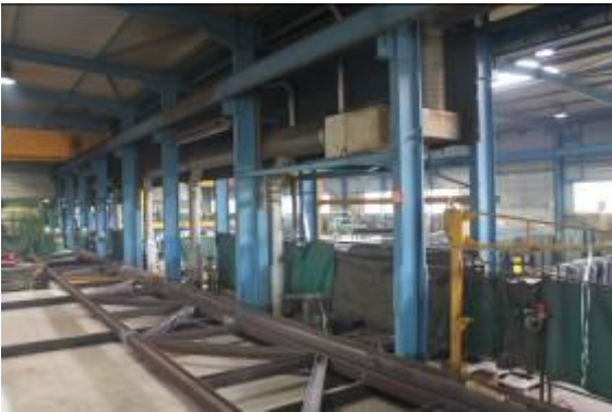
Montage à blanc d'une poutre treillis dans les ateliers BCM - Crédit photo : BCM
