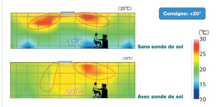
Enfin, les deux sondes fonctionnent simultanément afin de garantir une température d'air homogène sans aucun soufflage direct sur les occupants.
