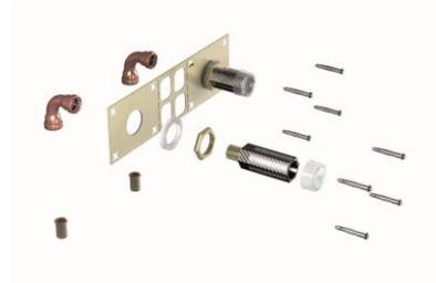
**L'installation de ComaplaK™ ne demande que quelques minutes et ne requière aucun outil.** Il ne reste plus qu'à connecter les tubes sur les raccords Tectite®, puis ces derniers aux sorties fileté. Un simple clic à l'intérieur du raccord indique que celui-ci est bien fixé. La plaque est ensuite fixée sur le mur au moyen des 8 vis et chevilles fournies dans le kit.
