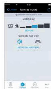
Réglage de la vitesse de ventilation et du flux de l'air
