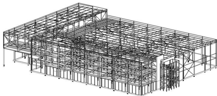
Au total, **650 heures d'études** ont été nécessaires pour la conception de ce meccano grandeur nature. L'ensemble de la charpente métallique a été assemblé sur site en seulement **5 semaines**, au moyen de 2 grues (automotrice et à tours) et 4 nacelles, avec 6 monteurs.
