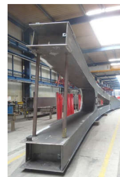
Fabrication de l'arc dans les ateliers de SMB
