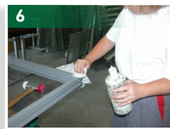
6 Nettoyage final après assemblage au moyen de nettoyant biodégradable AA409
