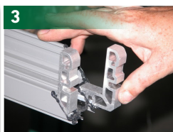
3 Mise en place des équerres d'assemblage
