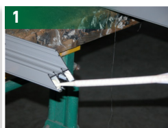
1 Extrusion de la colle hybride SP038 à l'intérieur de la chambre
