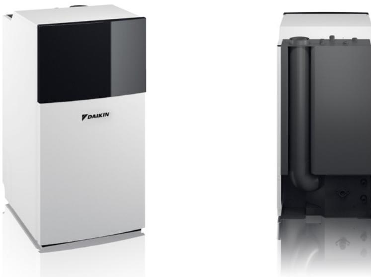
Daikin s'est appuyé sur le savoir-faire reconnu de Rotex, fort de plus de 20 ans d'expérience dans le domaine des chaudières à condensation fioul, pour mettre au point une nouvelle technologie de chauffage à brûleur modulant (modulation de 1:6). Celle-ci autorise une large plage de modulation à partir de 8 kW, multipliant les possibilités d'installation. La chaudière est disponible dans 3 puissances : 18, 24 et 32 kW.
