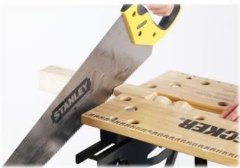
Tracer une ligne de coupe et scier les pieds à tailles égales, en fonction de la hauteur de meuble souhaitée. Réaliser la même opération pour la tige en bois qui fera office de bordure à l'avant de l'armoire.
