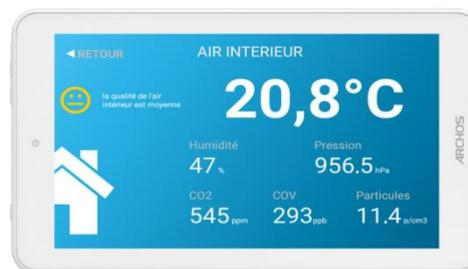
Simple à utiliser, la tablette Eoletouch offre la possibilité de **commander à distance la VPH** et de paramétrer le renouvellement de l'air de l'habitat lorsque l'utilisateur l'estime nécessaire.
