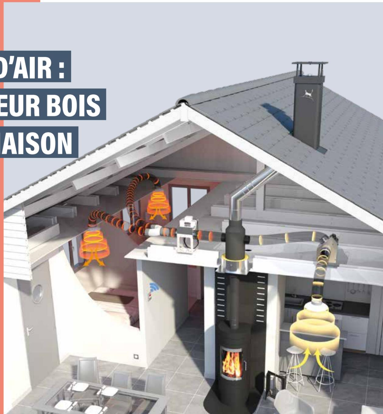
Le système AIRWOOD récupère l'air ambiant de la pièce de vie, puis réchauffe cet air dans le conduit échangeur et le redistribue dans toute la maison de façon homogène et efficace, par des bouches de soufflage.
