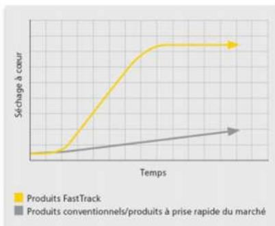
La technologie FastTrack offre un temps de prise et de séchage extrêmement courts.
