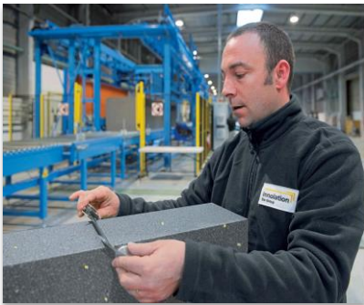
Fabrication des panneaux PSE de Sto sur le site d'Amilly (45) selon des procédés de fabrication et de contrôle à la pointe. Ici : contrôle de la précision dimensionnelle en sortie de découpe.
