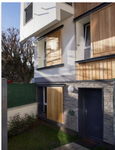
Petit collectif, Romainville (93) Solutions Sto : en parties basses StoVentec SCM plaquette de terre cuite sur chevrons bois, StoVentec R Enduits en R+1, 2 et 3. Maître d'ouvrage : OPH 93 Architecte : Benoît Bouvier, Paris. Crédit photo : Sto
