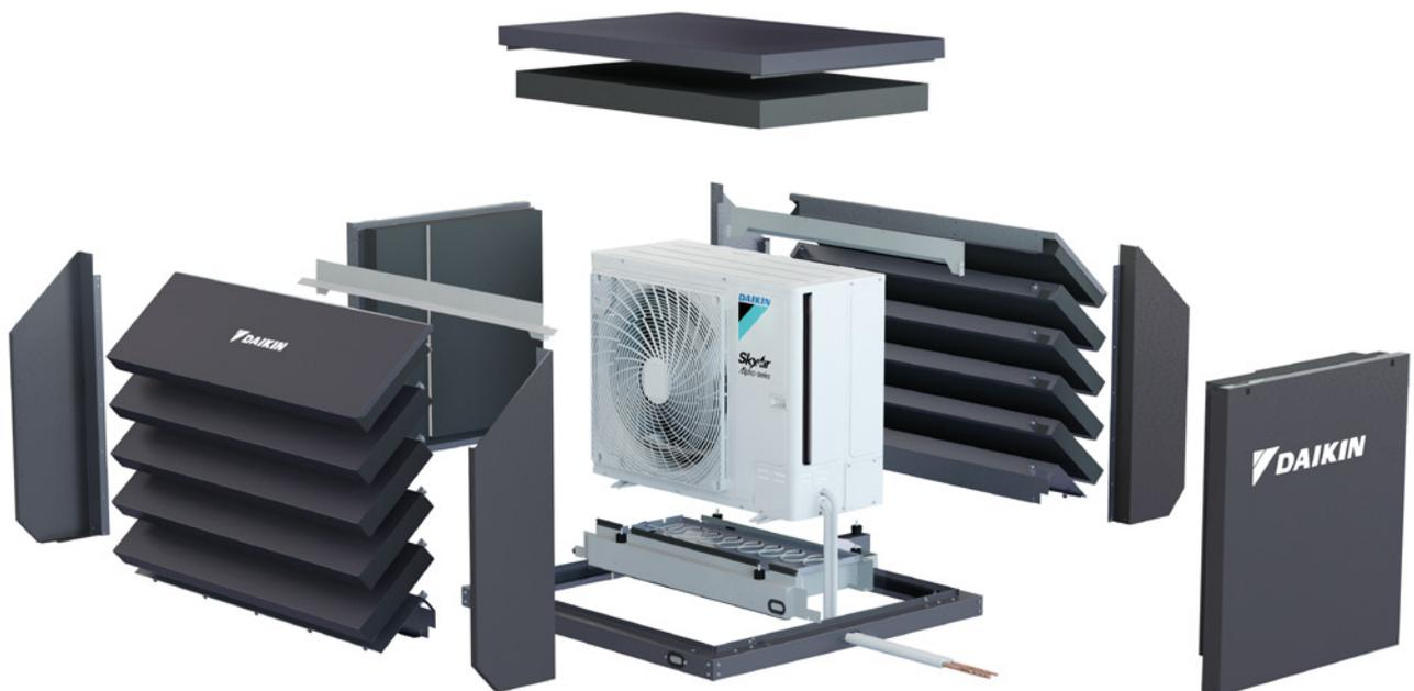
Cette réduction significative du niveau sonore est permise au moyen de panneaux d'isolation à haute densité ; à raison de 30 kilos de matériaux isolants de chaque côté du caisson. La partie supérieure du caisson bénéficie d'une séparation isolante de haute qualité afin d'éviter la circulation de l'air en intérieur.
