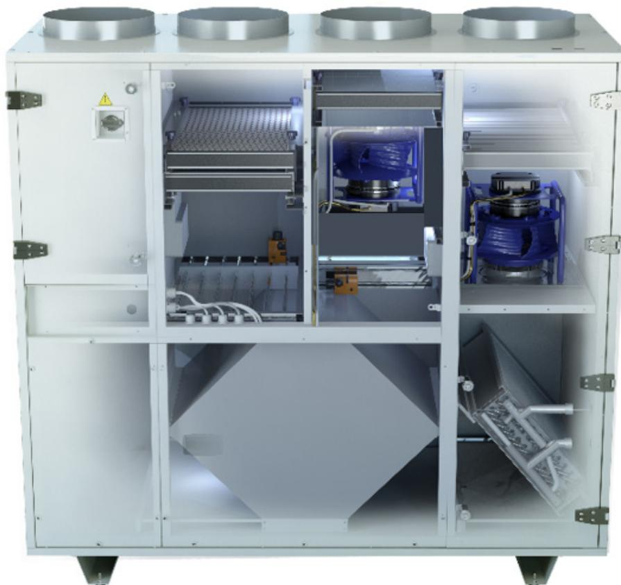
Son extrême compacité constitue l'un des grands atouts de cette série. Avec une profondeur maximale de 890 mm pour le plus grand modèle, l'installation s'en trouve facilitée pour les professionnels. La plus petite taille (taille 03) affiche une profondeur de 550 mm et les tailles intermédiaires mesurent 790 mm. En outre, les modèles les plus grands sont livrés en 2 ou 3 sections selon les tailles pour faciliter les opérations de transport et les différentes manipulations.
