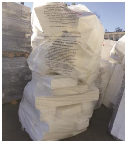
Recyclage des chutes de polystyrène expansé
