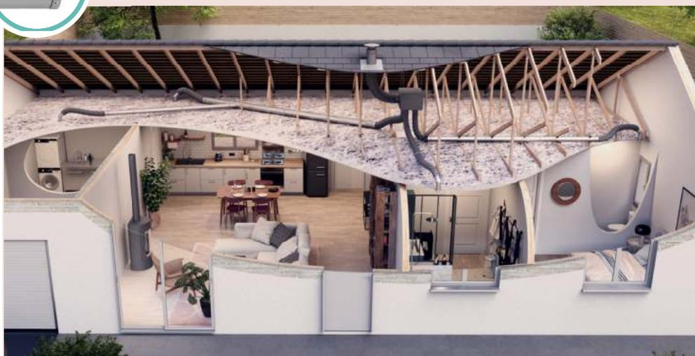
**Le conduit rigide modulaire isolé** présente tous les avantages pour un réseau de qualité durable, efficace et entretenable. **De conception rigide, isolé, circulaire avec un système d'emboîtement très facile, c'est la solution ventilation par excellence.** Rapide à mettre en œuvre, il offre une **performance aéroulique incomparable.**
