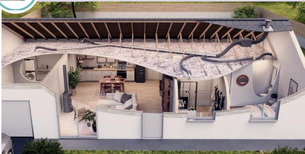
Pour un réseau équipé d'un **moteur mono-piquage**, le **conduit rigide modulaire isolé** est la **solution technique adaptée** – la réalisation d'un conduit principal avec les accessoires directionnels permettra de réaliser un réseau rigide raccordé à chaque bouche pour **garantir une performance de très haut niveau**.
