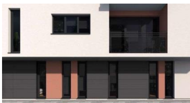
Rendu 3D d'un design en mixité ITE Enduit mince sur isolant laine de roche StoTherm Mineral (teintes d'enduit ocre et blanc) / bardage ventilé StoVentec FibreCement anthracite par panneautage horizontal en RDC.
