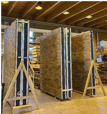
Essais sismiques qui se sont tenus en 2022 au FCBA à Bordeaux © Bouygues Immobilier
