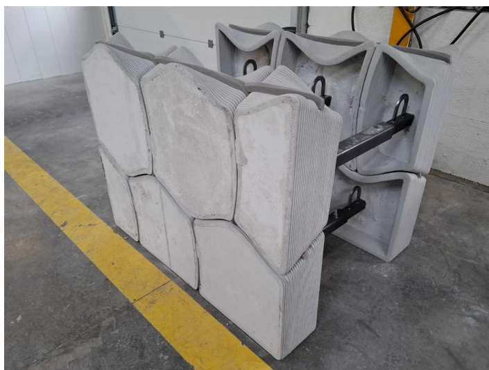
Prototype de système de coffrage perdu de forme complexe produit par Spie batignolles EmPrinte pour le compte de Westinghouse Electric Company
